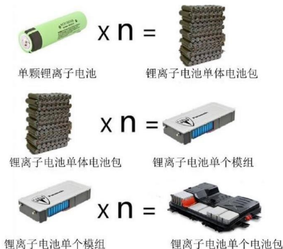
图4.1-1 典型汽车动力锂电池包的构成示意图
