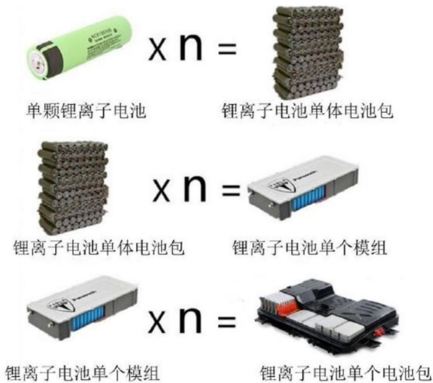
图 4.2-1 典型汽车动力锂电池包的构成示意图
