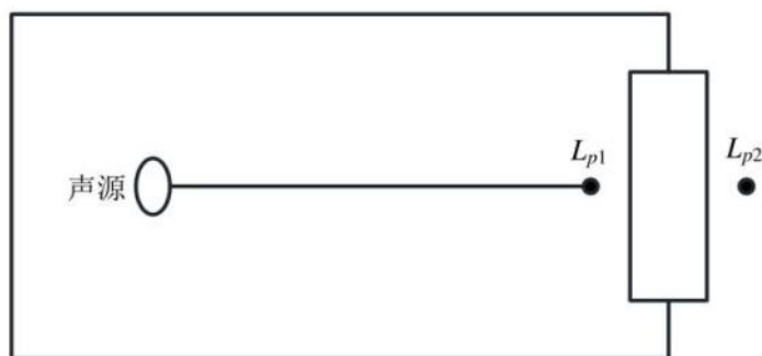
图 4-4 室内声源等效为室外声源图例
