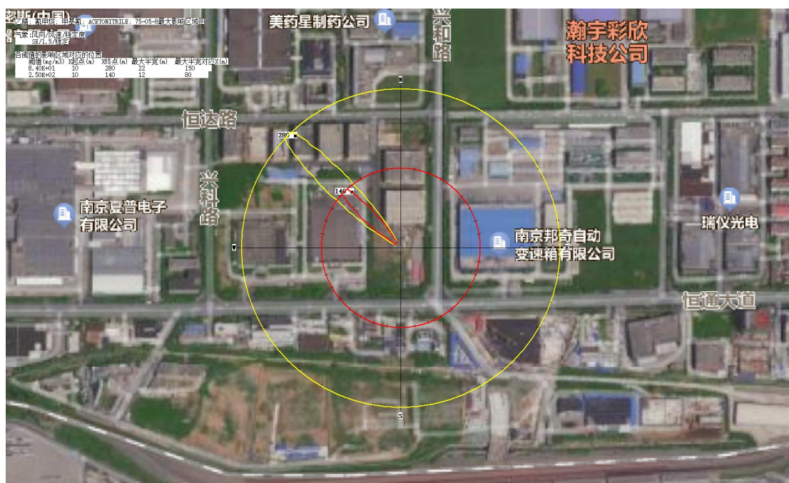
由预测结果可知,乙腈储罐泄漏后,在最不利气象条件下到达毒性终点浓度-1 的最远影响距离为 140m、到达毒性终点浓度-2 的最远影响距离为 280m。
