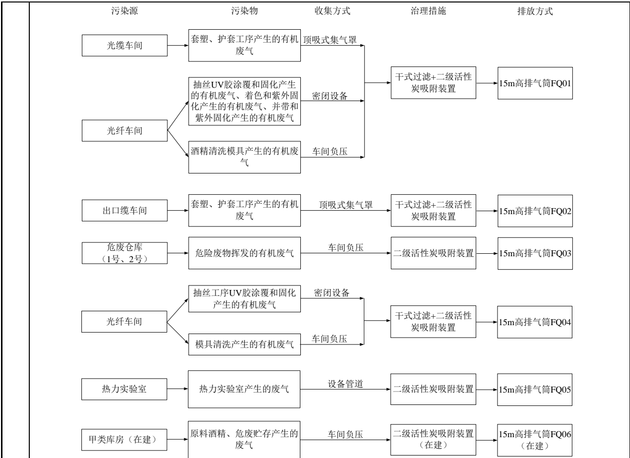
图2-5 现有项目废气收集处理路线图
