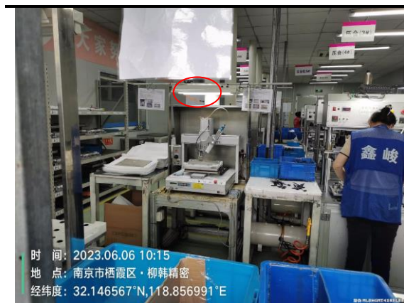
现有点胶废气收集效率低
