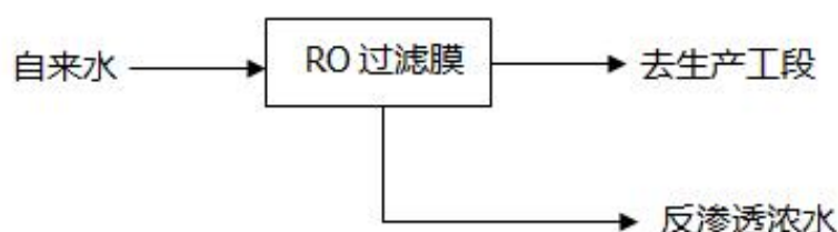
图 2-1 纯水制备生产工艺流程图
