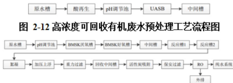
图 2-13 可回收有机废水系统工艺流程图
