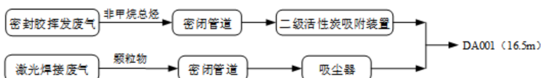
图 4-1 项目废气治理流程图
