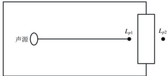
图 4-7 室内声源等效为室外声源图例
