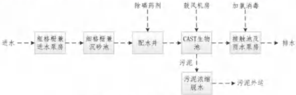
图4-2 仙林污水处理厂工艺流程图
