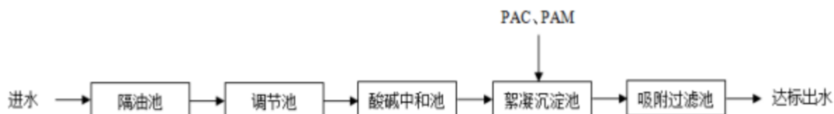
图 4-4 厂区污水处理设施工艺流程图
