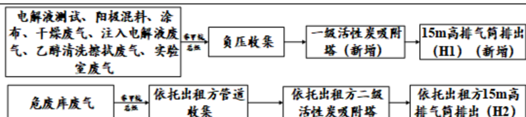
图 4-3 废气治理工艺及流程走向图
