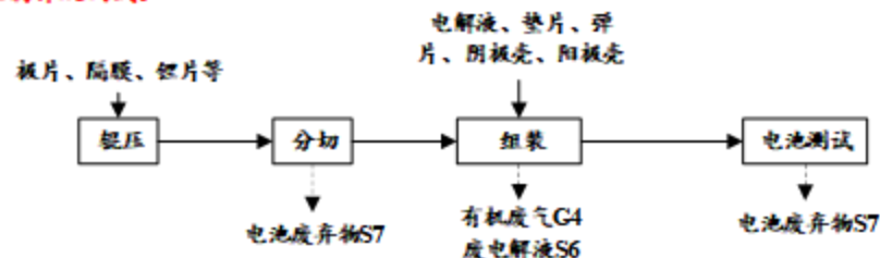
图 2-3 实验室测试流程及产污节点示意图
